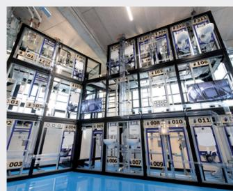
L'apprentissage par la démonstration : les écoulements hydrauliques des eaux usées et des eaux vanne sont visibles à travers des tubes transparents, permettant la simulation, d'erreurs de raccordement et de mettre en avant les bonnes pratiques.
